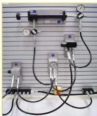
*Устройства соединяются друг с другом с помощью шлангов с самоуплотняющимися быстроразъемными соединениями. Это гарантирует нулевые утечки жидкости даже во время операций подключения / отключения.*
